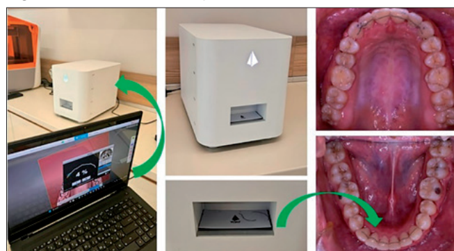
Фиг. 2: Дигитално управлявано роботизирано огъване на ретенционна гъга
